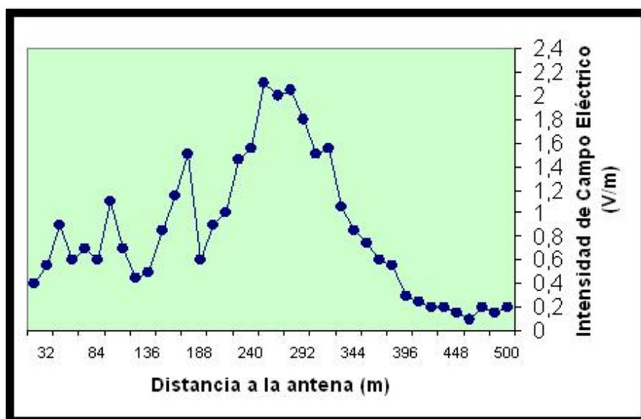
**Figura 3.** Variación de la Intensidad de Campo Eléctrico a nivel del suelo al alejarnos de una estación base de telefonía situada en el tejado de un edificio,
