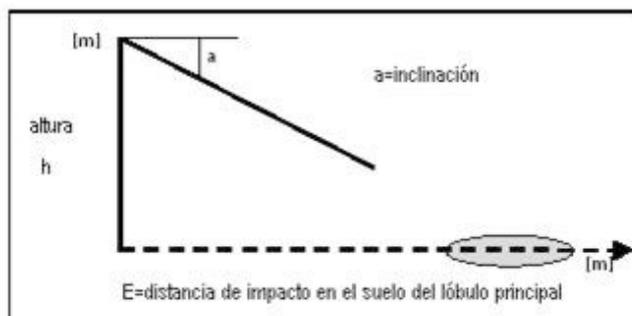
**Figura 2.** La distancia ( $E$ ) de la superficie principal de incidencia del lóbulo en el suelo se obtiene por la fórmula:  $E = \tan(90-a) \times h$ , siendo  $a$  el ángulo de inclinación de la emisión de la antena respecto a la horizontal y  $h$  la altura a la que está instalada. (Adaptado de Eger et al., 2004).
